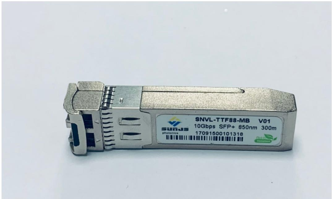
工业级光模块根据工作温度范围可划分为商业级（0℃~70℃）、扩展级（-20℃~85℃）、工业级（-40℃~85℃）。一般用于室内的工业级光模块只需要用商业级工业级光模块即可，但如果将工业级光模块用于室外等温度不确定且波动大的恶劣环境下（例如：野外偏远山区、隧道等），则需要工业级光模块。一般用于室内的工业级光模块只需要用商业级工业级光模块即可，但如果将工业级光模块用于室外等温度不确定且波动大的恶劣环境下（例如：野外偏远山区、隧道等），则需要工业级光模块。
